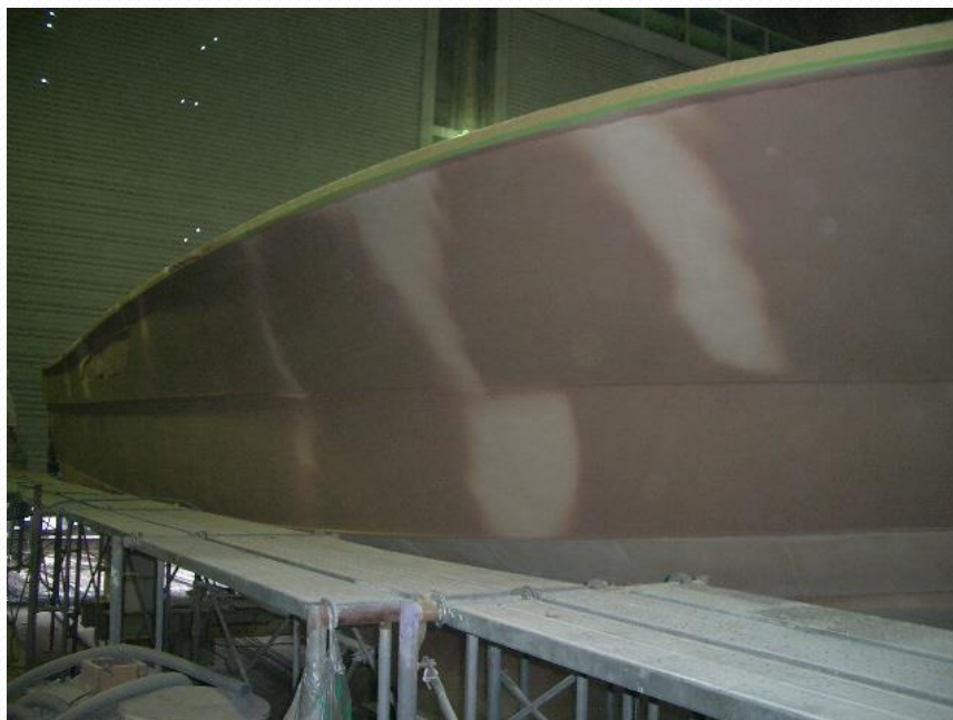
スプレИАブル 吹き付けパテ塗装 この工程でフェアな面を完成させる
