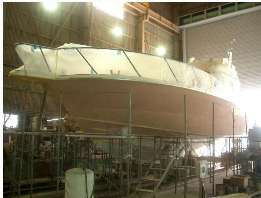
ハイビルドエポキシプライマー塗装 最終545エポキシプライマー塗装
